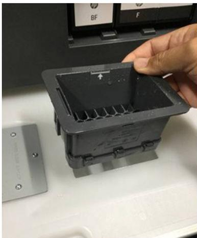
2. Limpie el filtro con un cepillo suave y agua con jabón caliente tanto por el interior como por el exterior. Asegúrese de enjuagarlo bien antes de volver a colocarlo en la impresora. Puede utilizar agua del grifo para limpiar y enjuagar el filtro.
