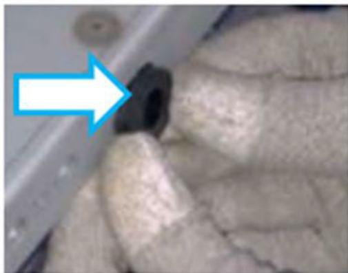
Los ojales se encuentran detrás de las molduras (busque los triángulos acanalados en la moldura como se muestra en las llamadas más abajo) también indicados con círculos azules de línea discontinua.
